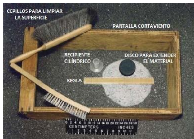
Figura 791 - 1. Elementos para medir la profundidad de macrotextura superficial
